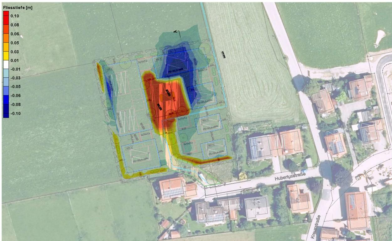
Abbildung 10.4: Differenzendarstellung Fließgeschwindigkeiten Plan- Ist, HQ<sub>100</sub>, 45-Minuten-Regen (Geobasisdaten: Bayerische Vermessungsverwaltung, 2022)
