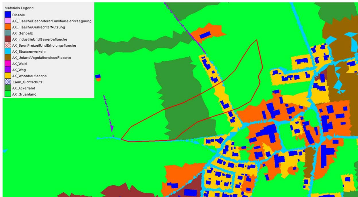
Abbildung 6.2: Materialbelegung 2d-Abflussmodell
